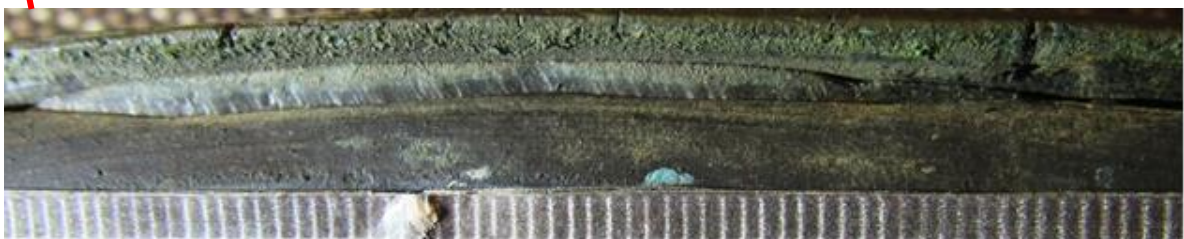
Деформована (вдавлена) ділянка, виявлена на торцевій поверхні автомобільного ущільнювача скла
