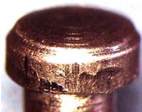
Зображення 16. Блокуючі штифти зі слідами контакту з каналом корпусу.
