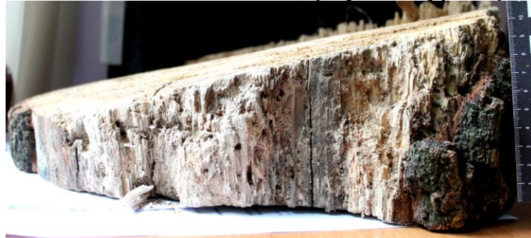
Зображення 9. Загальний вигляд трухлявості дерева на боковій поверхні зрізу стовбура дерева.
