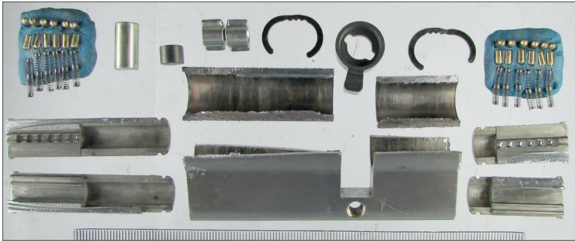
Зображення 10. Загальний вигляд циліндрового механізму замка після його розбирання.
