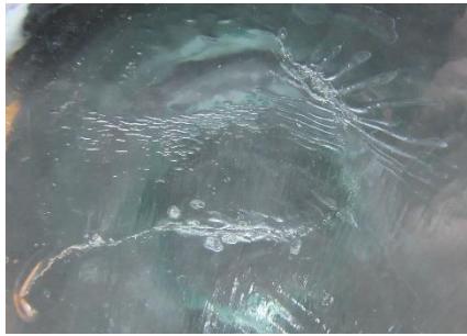
Рисунок 6 – Дефекти витяжки скляних трубок
