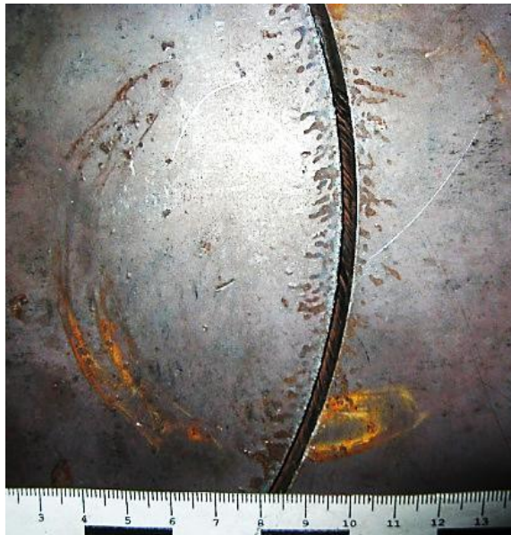
Зображення 12. Вигляд збігу між слідами окису металу на плиті та крузі, що виникли під час зберігання суцільного виробу з металу
