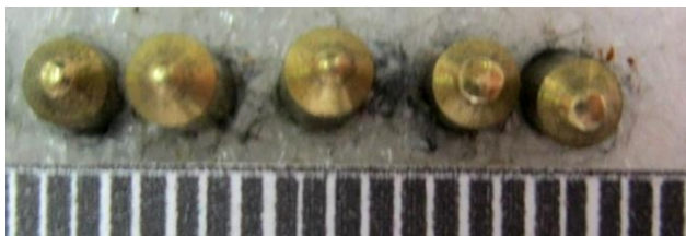
Зображення 37. Загальний вигляд конічних поверхонь робочих штифтів внутрішнього циліндру.
