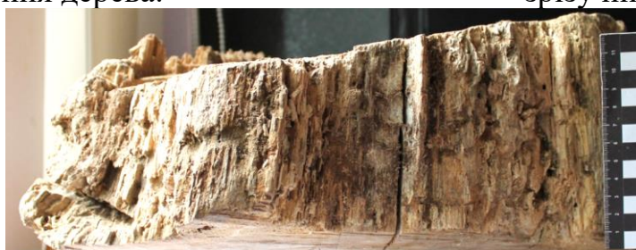
Зображення 3. Загальний вигляд трухлявості деревини на боковій поверхні зрізу пня дерева.
