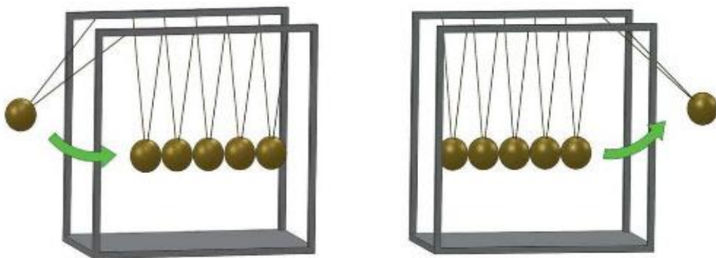
Зображення 2. Передача імпульсу на прикладі дії «маятника Ньютона».
