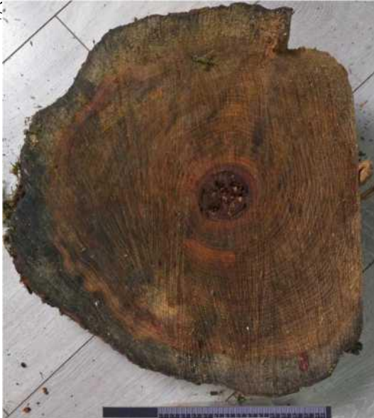
Рисунок 9. Торцевий зріз фрагмента деревини при неналежному зберіганні під впливом природних умов.
