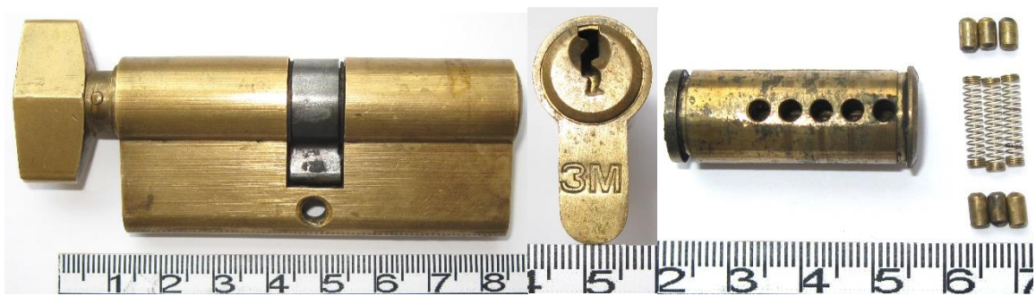
Зображення 9-11. Несправний замок, але придатний до експлуатації, що супроводжується зниженням ступеню таємності механізму.
