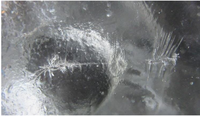
Рисунки 7, 8, 9, 10 – Дефекти, що відображаються на скляних виробках
