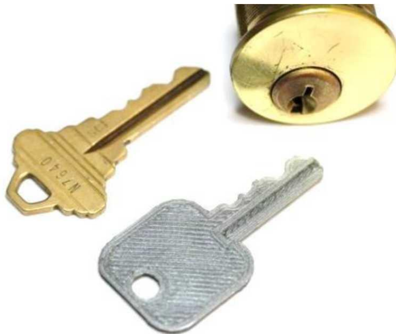
Зображення 17. Приклад виготовленого на 3D принтері ключа-копії із ключем-оригіналом та циліндровим механізмом.
