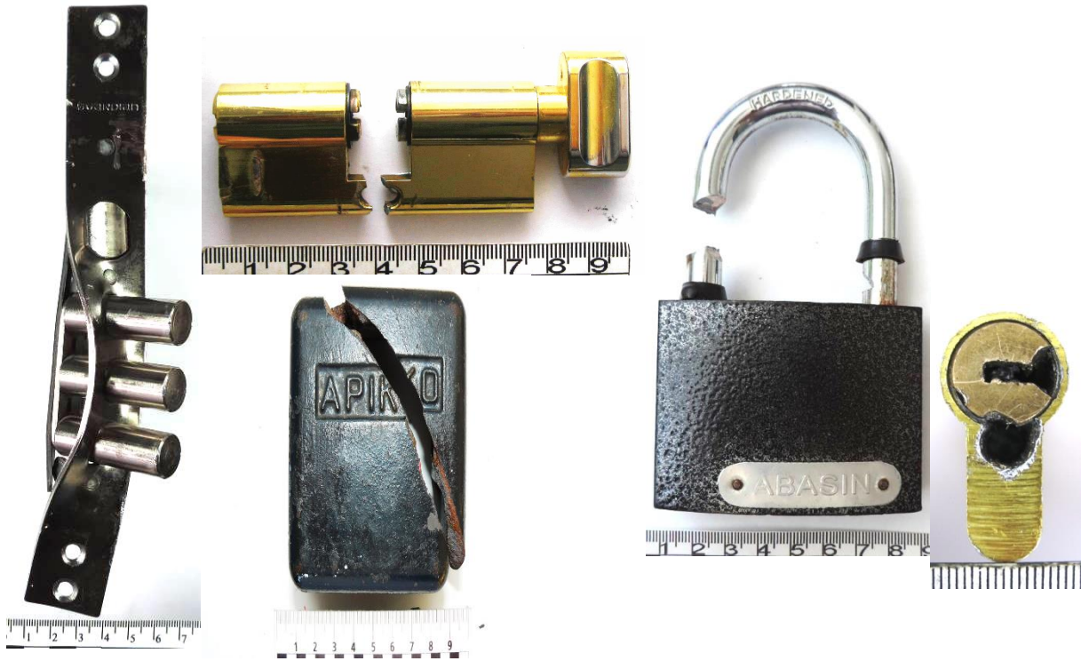
Зображення 4-8. Замки у несправному та непридатному стані.
