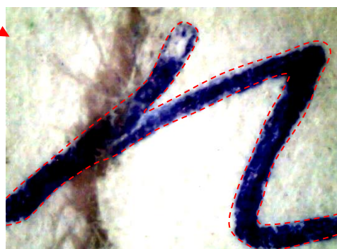
Зображення 4. Збільшений вигляд літери «п» при повному суміщенні двох фрагментів паперу
