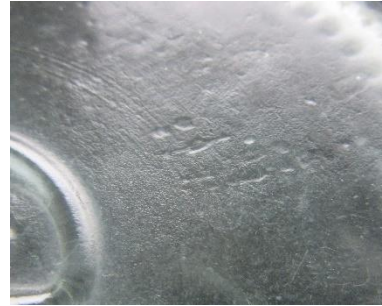
Рисунок 6 – Дефекти витяжки скляних трубок
