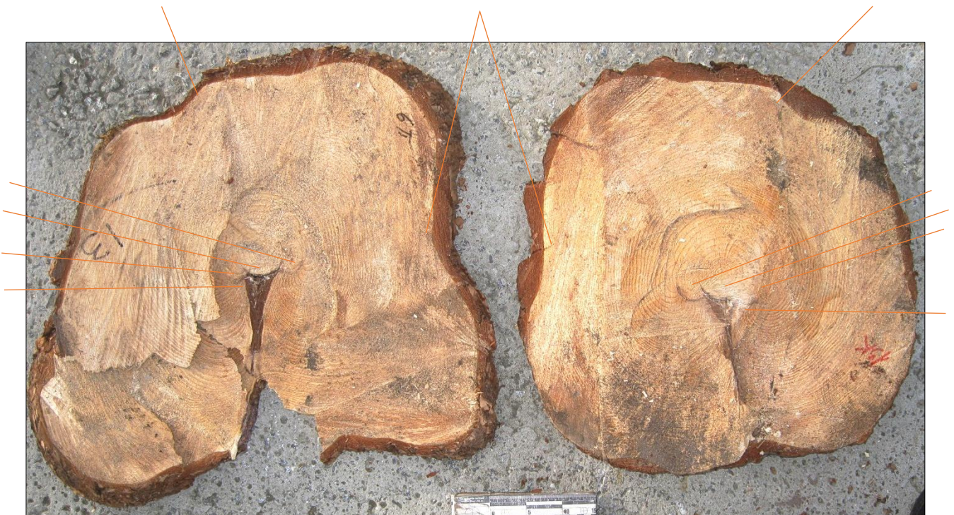
Зображення 1. Загальний вигляд зіставлених зрізу з пня (ліворуч) та зрізу з колоди дерева (праворуч), з розміткою ознак, що збігаються.
