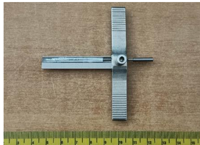
Зображення 2. Комплект самоімпресійної відмички у зібраному вигляді.
