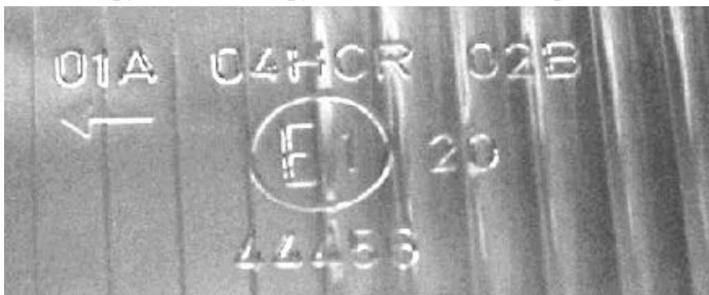
Зображення 8. Вигляд буквенно-цифрового маркування на оптичному елементі фарного розсіювача.
