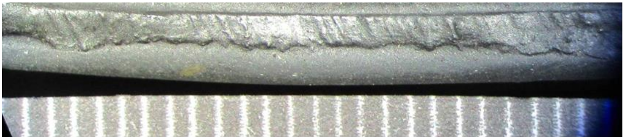
Експериментальний відтиск виконаний з ділянки розміщеної в місці для кріплення лобового скла автомобіля УАЗ 452
