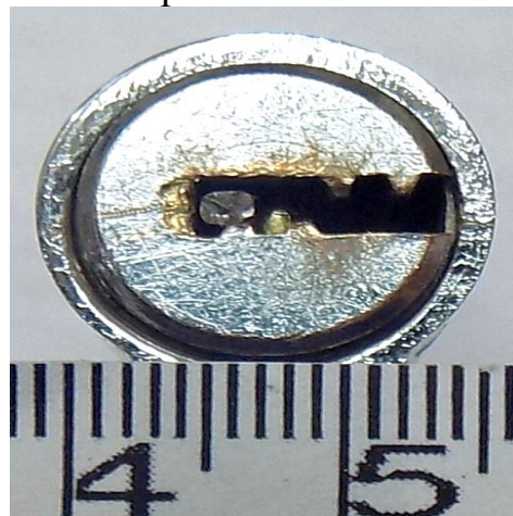
Зображення 1. Сторонній предмет (фрагмент відмички), виявлений в каналі для ключа візуальним оглядом.
