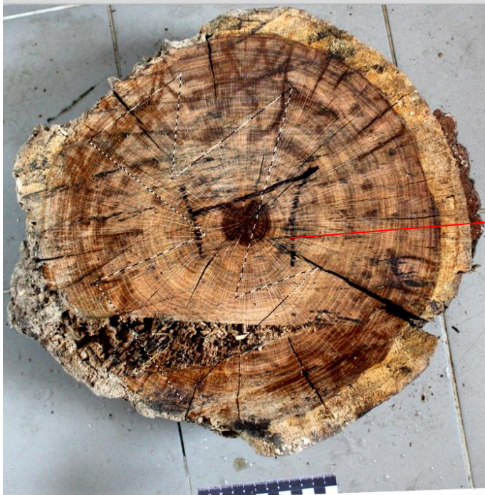
Зображення 17. Загальний вигляд торцевої поверхні зрізу пня з виділеною ділянкою візерунків річних кілець та тріщин.
