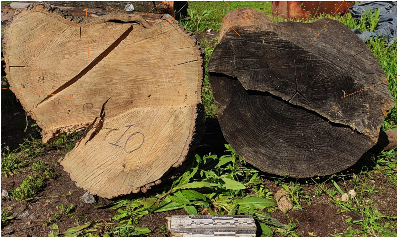
Зображення 7. Загальний вигляд зіставлених зрізу з пня (ліворуч) та колоди дерева (праворуч), з розміткою ознак, що збігаються.
