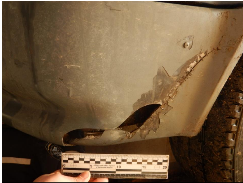
Пошкодження переднього бамперу автомобіль марки «Ford Transit», д.н.з. 13667 МА.
