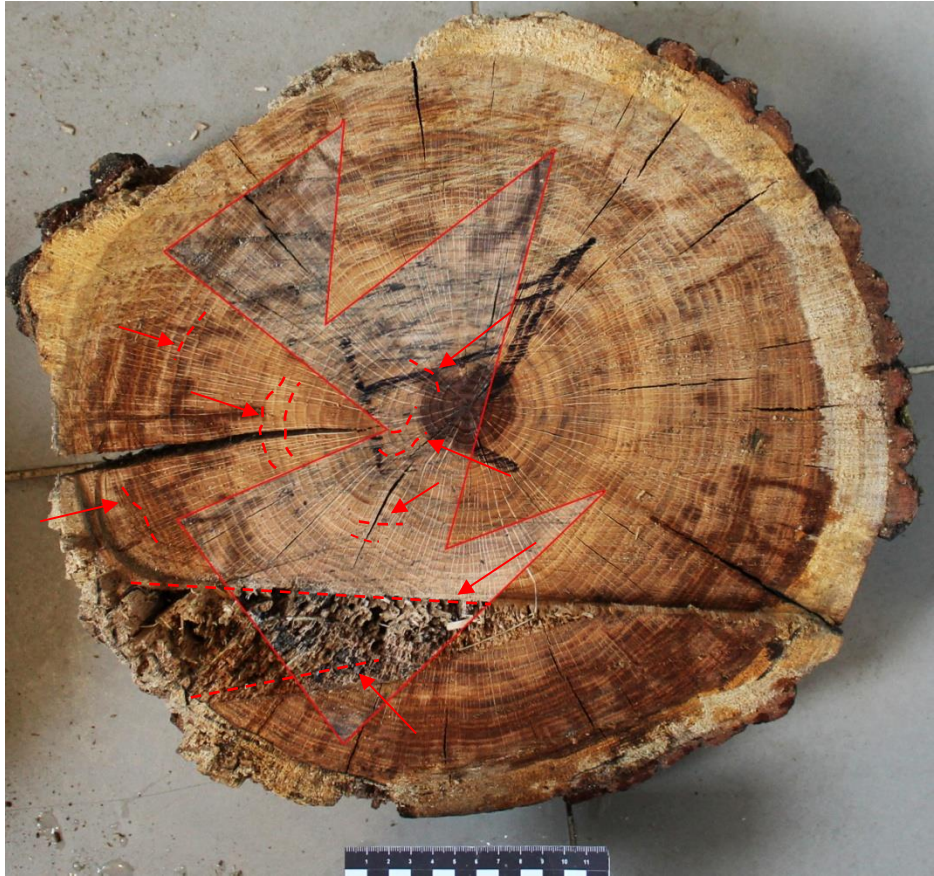
Зображення 19. Порівняльне дослідження способом накладання: ділянки візерунку річних кілець торцевої поверхні зрізу пня на торцеву поверхню зрізу стовбура дерева.
