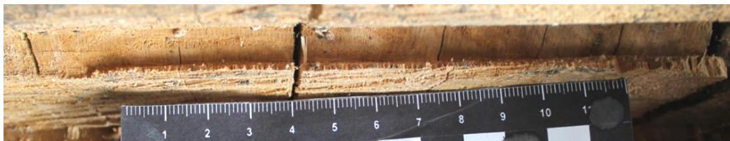
Зображення 5. Загальний вигляд надпилу на досліджуваній поверхні зрізу пня дерева.
