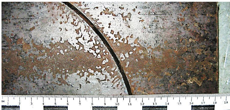
Зображення 13. Вигляд збігу між слідами окису металу на плиті та крузі, що виникли під час зберігання суцільного виробу з металу
