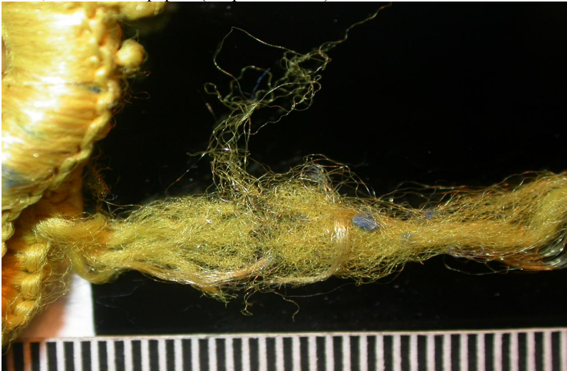
Зображення 21. Суміщення краю нитки, який виступає з обробленого «оверлком» манжета рукавички на ліву руку (зліва) та краю нитки, вилученої при ОМП (справа).
