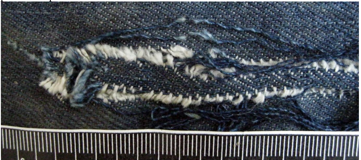
Зображення 17. Суміщення фрагменту тканини з двома виступаючими нитками синього кольору та верхньої частини «П»-подібного пошкодження з двома нитками, що виступають з нижнього краю пошкодження.
