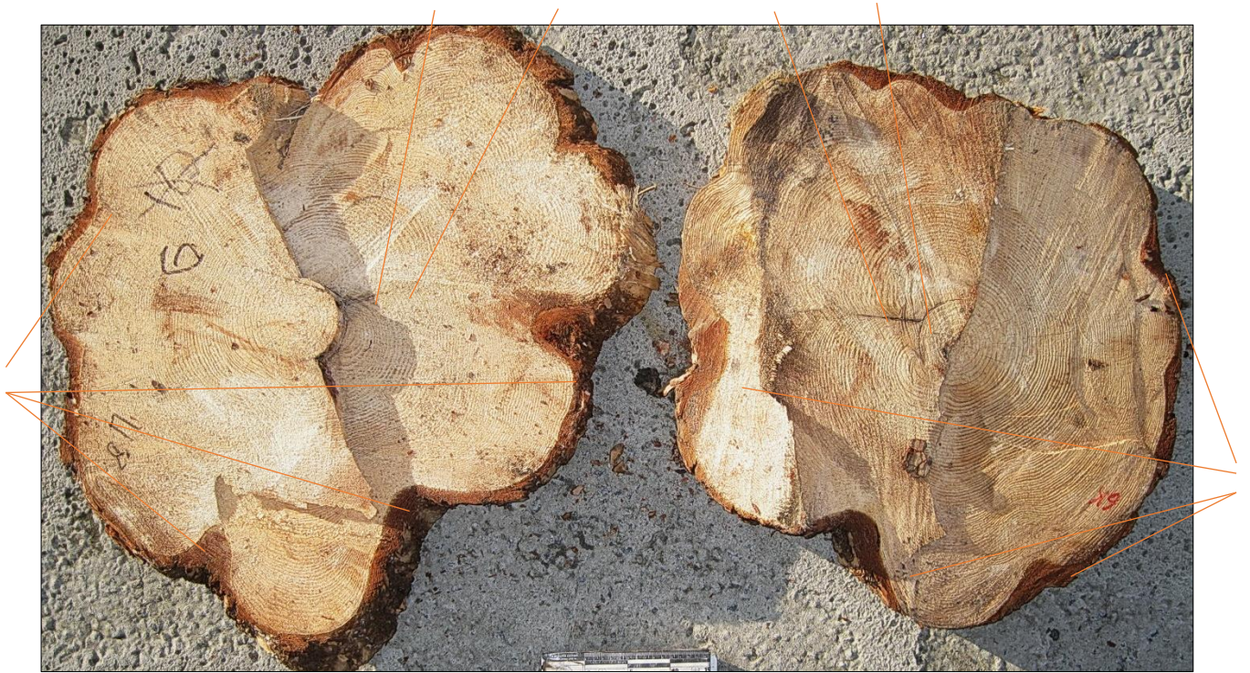
Зображення 2. Загальний вигляд зіставлених зрізу з пня (ліворуч) та зрізу з колоди дерева (праворуч), з розміткою ознак, що збігаються.
