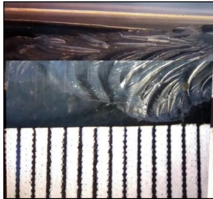
Зображення 6. Накладення збільшеного зображення ділянки сліду повного розділення на розсіювачі фари автомобіля та збільшене зображення ділянки сліду повного розділення на уламку розсіювача автомобільної фари.
