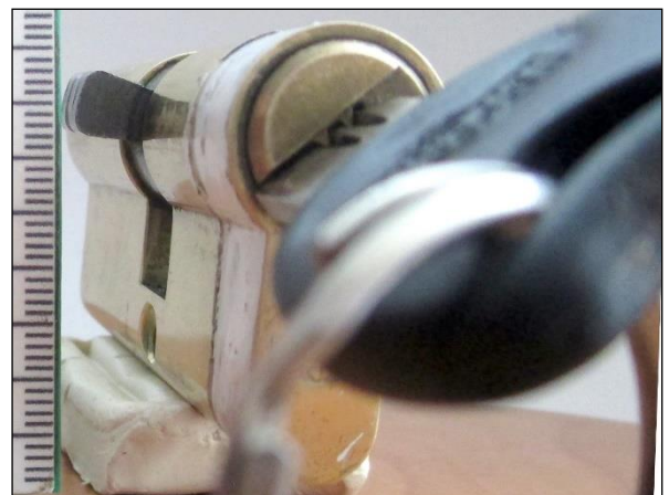
Зображення 9. Положення ключа, циліндру та поводку після повертання ключа.
