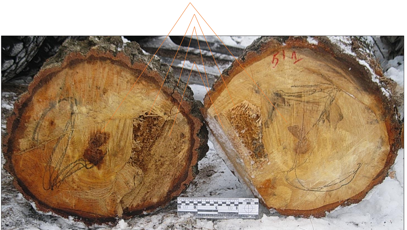
Зображення 5. Загальний вигляд зіставлених зрізу з пня (ліворуч) та колоди дерева (праворуч), з розміткою ознак, що збігаються.
