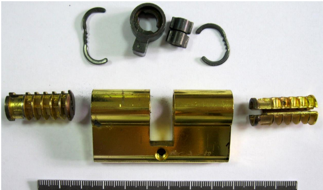
Зображення 29. Загальний вигляд корпусу та складових частин замка.
