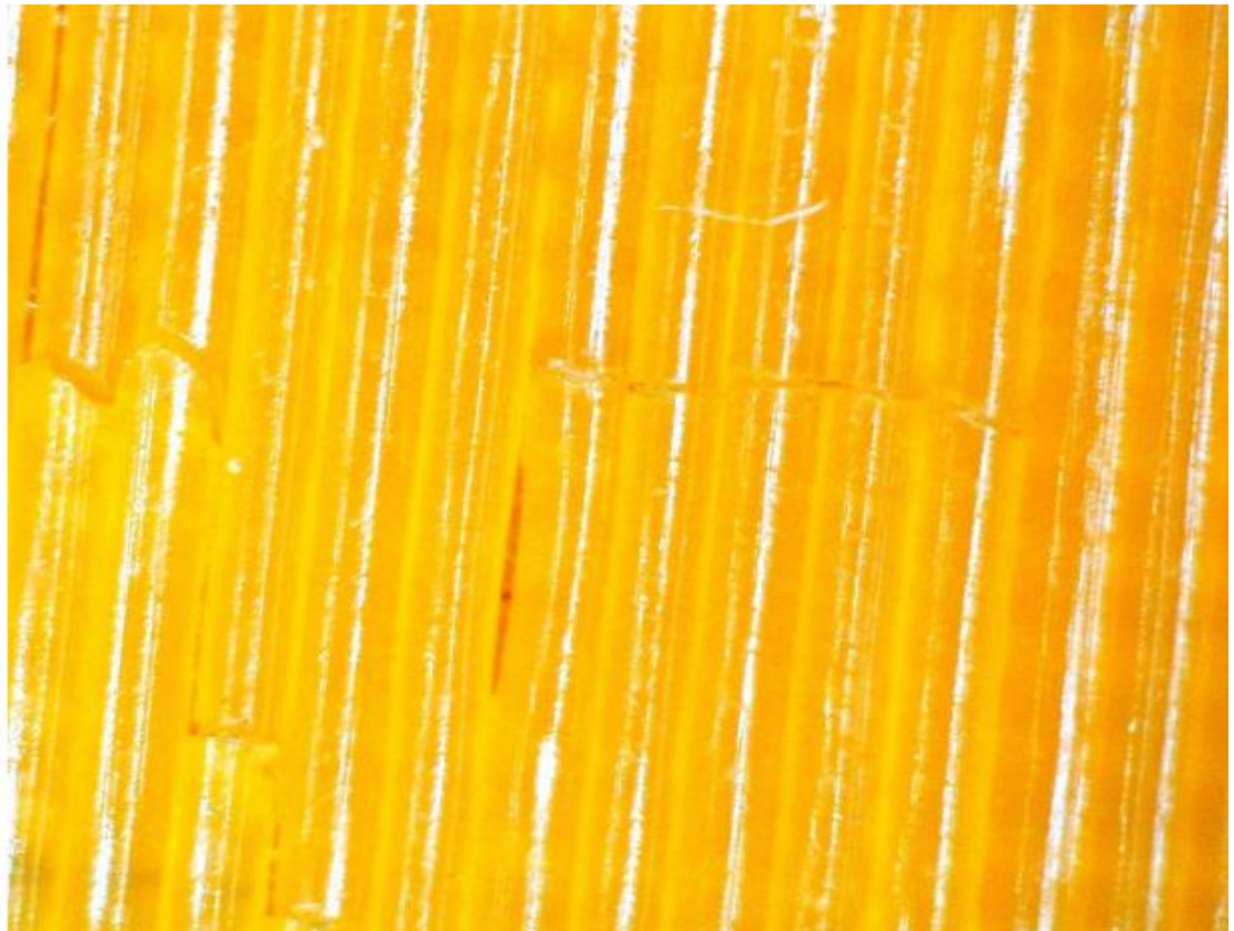
Зображення 9. Детальний вигляд структури деталі надрукованої на 3D принтері.
