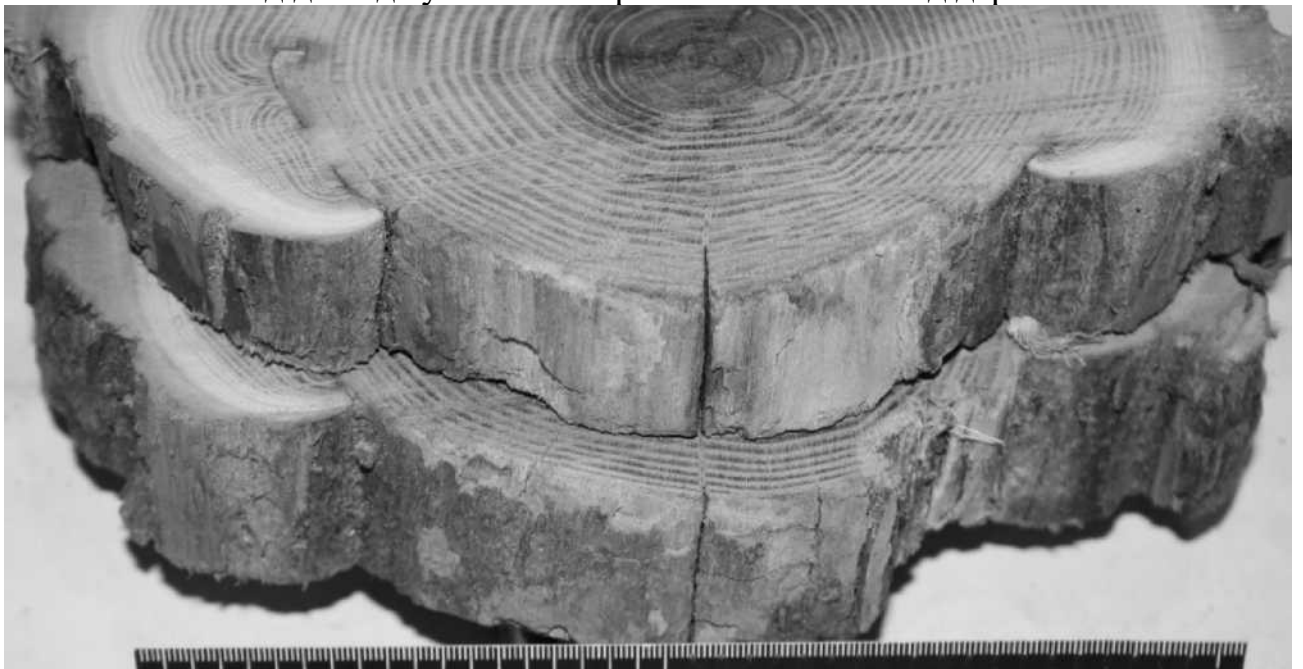
Збіг за місцями розташування пошкоджень кори та тріщин
