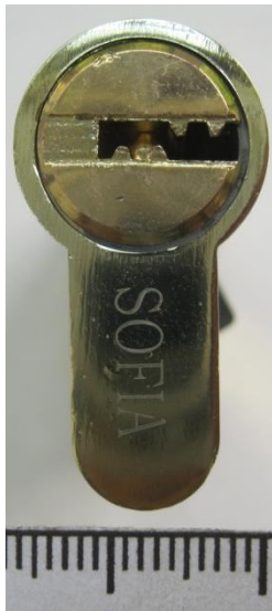
Зображення 5. Загальний вигляд торцевої сторони зведеного циліндрового механізму з ключовою шпариною з зовнішньої сторони.
