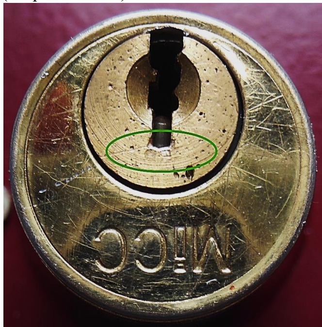
Зображення 21. Торцева частина циліндру зі слідами впливу упорного плеча стрижня бамп-ключа, які розташовані біля основи ключової шпарини.
