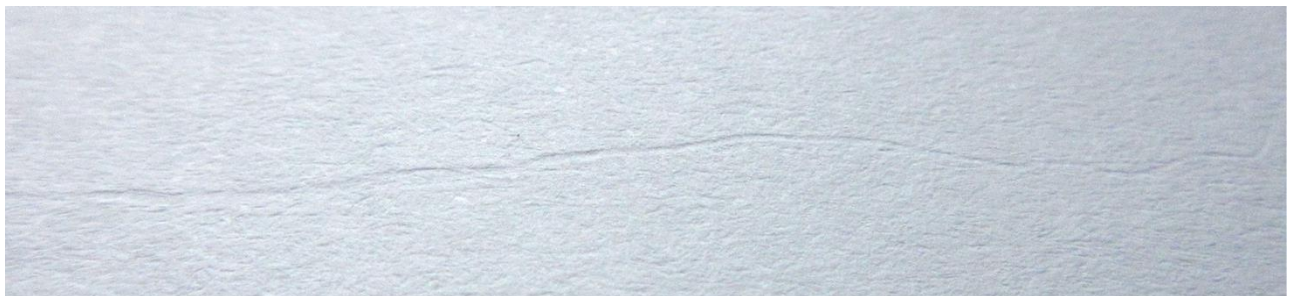
Рисунок 5 – Складка на папері (виробнича ознака)
