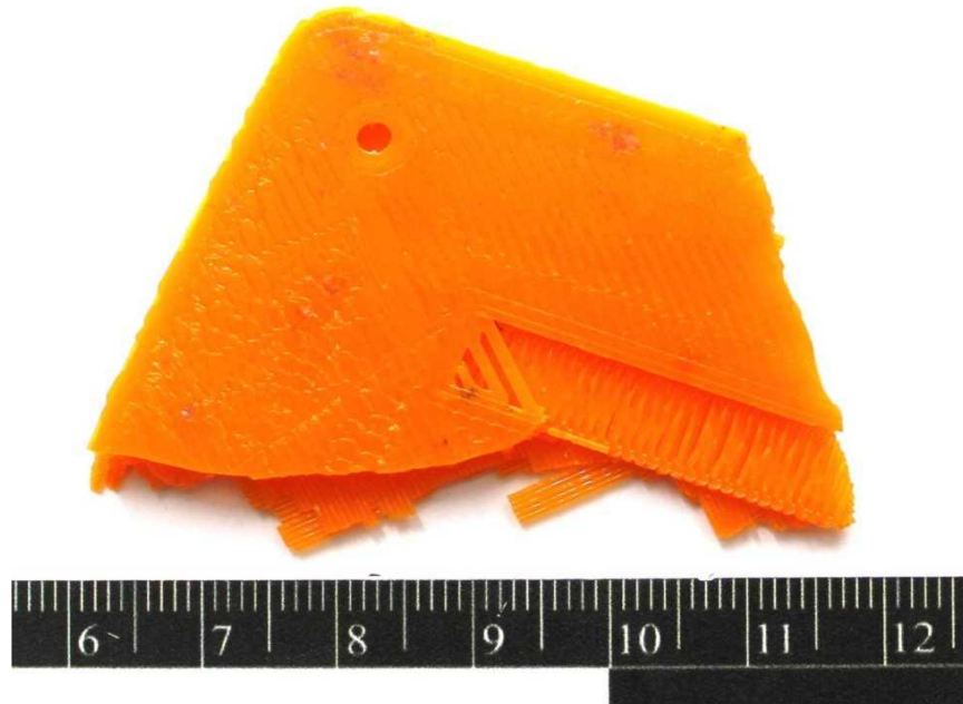
Зображення 16. Приклад виготовленої на 3D принтері деталі із складною внутрішньою структурою та наявним розламом.
