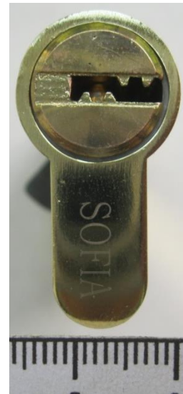
Зображення 6. Загальний вигляд торцевої сторони зведеного циліндрового механізму з ключовою шпариною з внутрішньої сторони.
