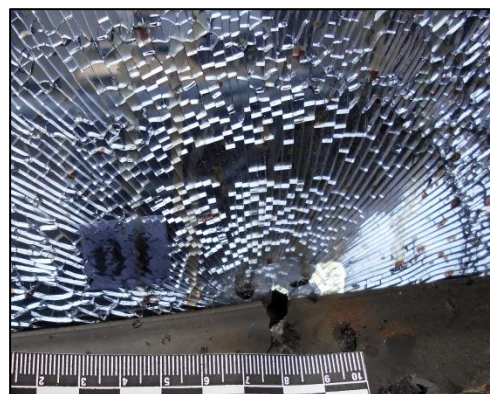
Рис. 3. Вигляд кульового пошкодження на склі (з внутрішньої сторони).
