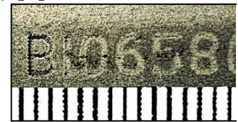
Рис. 6. Зображення маркувального позначення, застосування електрохімічного травлення.
