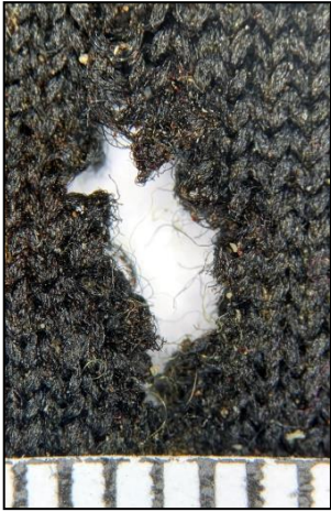
Рис. 7. Вигляд кульового пошкодження на одязі.
