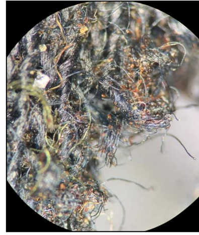
Рис. 8. Збільшене зображення пошкоджених волокон матеріалу зі слідами пострілу.
