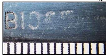
Рис. 5. Зображення маркувального позначення, оброблення шліфувальним папером.
