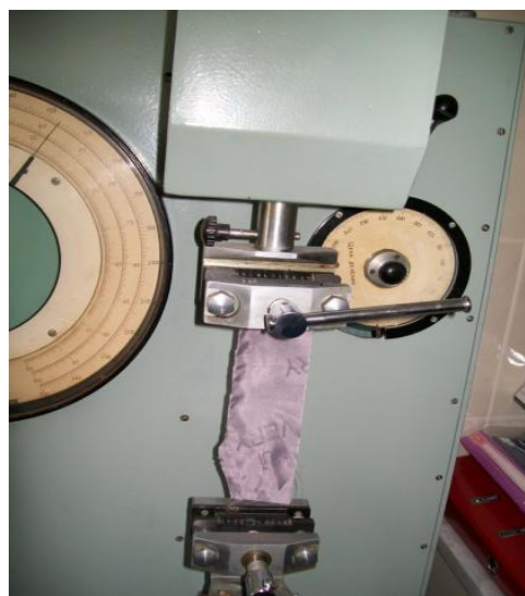
Рис. 7. Фотографічне зображення вимірювання розривального зусилля тканини підкладкової із синтетичних ниток фірми «Wujiang Xinhuali Textile Co., Ltd»
