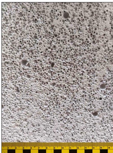
Рис. 1. Зближений вигляд внутрішньої структури виробів із ніздрюватого бетону.
