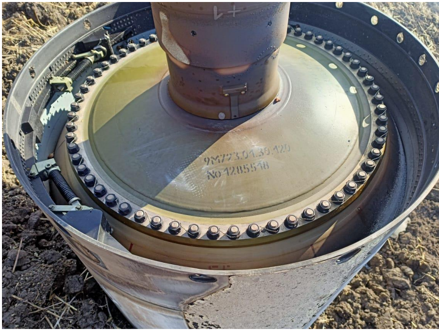
Рисунок 2. Ракетна частина ракети «Кинджал» з маркуванням «Іскандеру»
