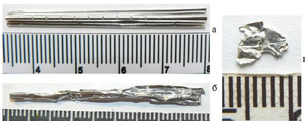
Рис. 3. Стандартна заготовка з фольги (а); деформована (використана) заготовка з фольги, виявлена на місці події (б); фрагмент заготовки з фольги, виявлений у циліндрі при дослідженні циліндрового замку (в).
