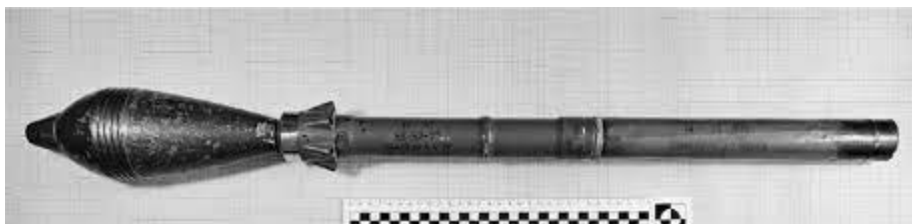
Рисунок 2. Саморобний вибуховий пристрій на основі корпусу 82-мм мінометної міни та маршового і стартового порохів двигунів пострілу ПГ-7.
