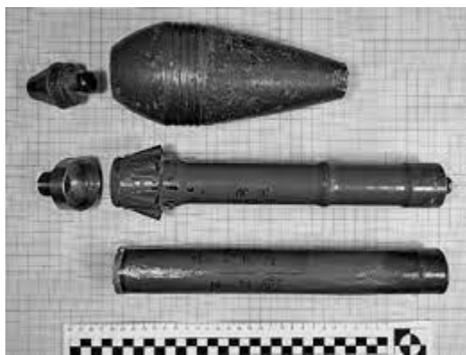
Рисунок 3. Складники саморобного вибухового пристрою на основі корпусу 82-мм мінометної міни та маршового і стартового порохів двигунів пострілу ПГ-7.
