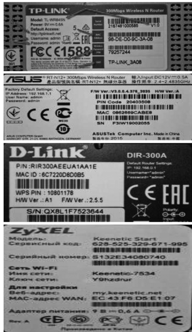
Рис. 1 Загальні дані роутерів різних моделей, що містяться на їх звороті
