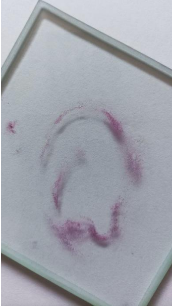
Зображення 26. Зразок відібраний методом фарбування на скельце.
