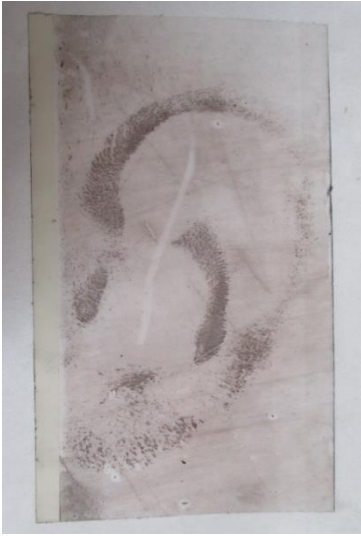
Зображення 22. Зразок відібраний методом вилучення на липку стрічку
