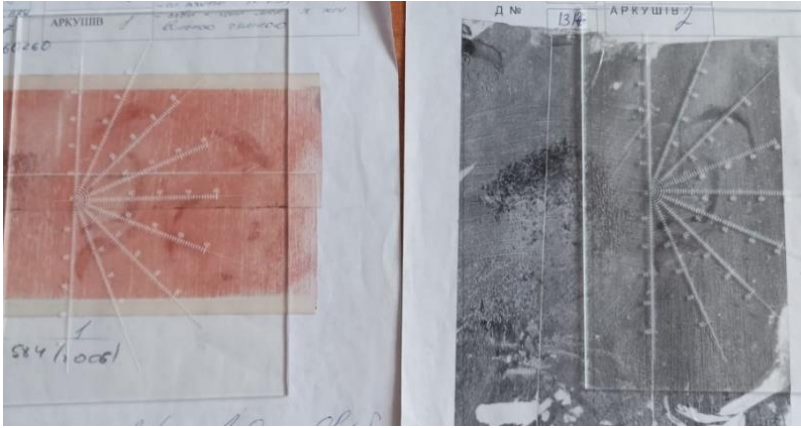
Зображення 73: Одночасне накладання лінійок для визначення відповідності розмірів елементів та відстаней їх положення в слідах вушних раковин
