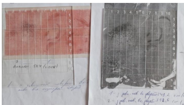
Зображення 76: Одночасне накладання пластинок з координатними сітками для визначення відповідності положення елементів в порівнювальних слідах вušних раковин.
