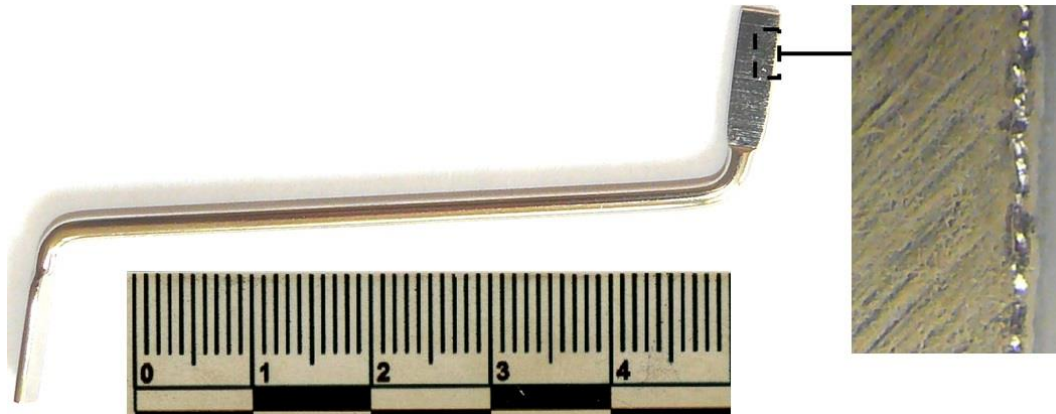
Рис. 2. Мікрорельєф ділянки робочої частини воротка, виготовленого промисловим способом.
