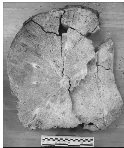
Рисунок 2. Зрізи дерева породи смерека з ознаками пошкодження деревини під впливом різних умов навколишнього середовища: 1 – тріщина; 2, 3 – загнивання; 4 – розлам.
