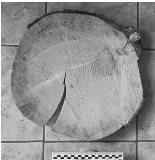
Рисунок 3. Вигляд тріщини на поверхні дерев'яного зрізу (1) і вигляд нашарування плісняви на поверхні дерев'яного зрізу (2).
