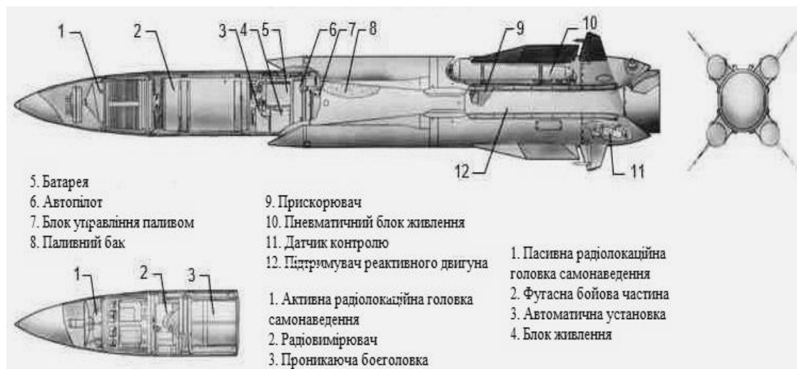
Рис. 1 Загальна конструкція базової ПРЛР Х-31П
