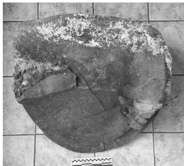
Рисунок 3. Вигляд тріщини на поверхні дерев'яного зрізу (1) і вигляд нашарування плісняви на поверхні дерев'яного зрізу (2).
