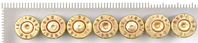
(a) Impresiunile create de percutor pe capsele de aprindere a tuburilor cartușelor marca S&B
