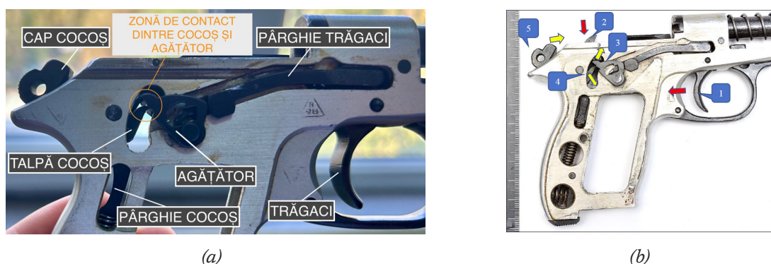
Fig. 2.3 Pistol model 1974 cal. 7,65x17SR mm – elementele reprezentative ale mecanismelor funcționale (a) și schema de organizare și deplasare relativă a acestora (b), în care: 1 - trăgaci, 2 - declanșator/pârghie de dezarmare, 3 - agățător, 4 - talpa cocoșului, 5 - capul cocoșului
