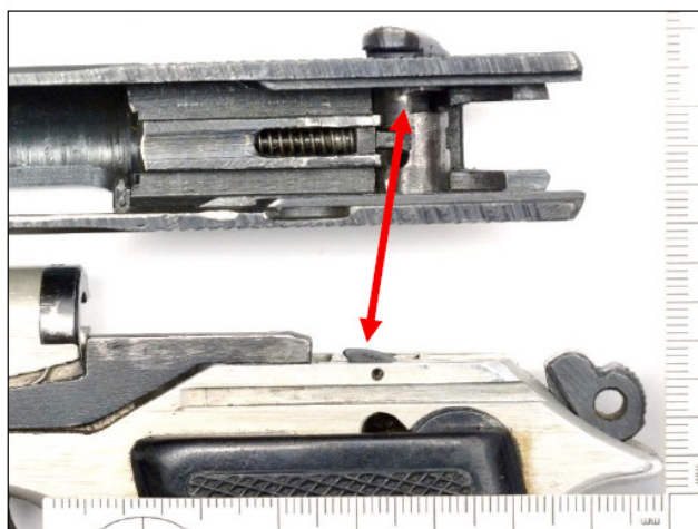
Fig. 2.4 Piedica de siguranță în poziția „Sigur” și cocoșul armat. Săgeata indică regiunea inferioară a piedicii de siguranță care, la acționarea piedicii de siguranță în sensul asigurării, determină împingerea pârghiei de dezarmare ce cauzează decuplarea contactului menținut între pragul agățătorului și talpa cocoșului armat, acesta fiind eliberat
