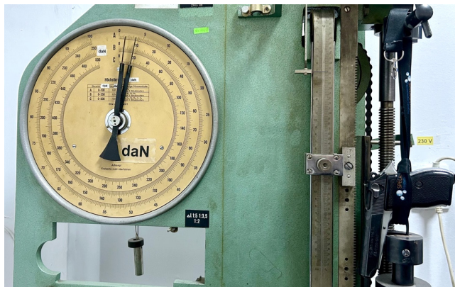
Fig. 3.1 Aparatul de încercări mecanice prin tracțiune VEB Thuringer ZMGi 500, împreună cu unul dintre pistoalele supuse testării
