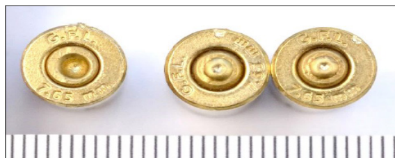
(b) Impresiunile create de percutor pe capsele de aprindere a tuburilor cartușelor marca GFL
