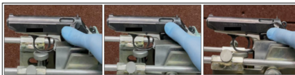
Fig. 3.3 Procedura de verificare experimentală a funcționării mecanismului de siguranță, prin acționarea piedicii de siguranță din poziția „Foc” în poziția „Sigur”
