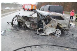
Рис. 6. Автомобіль аналог з бази даних DSD (середня EES 80 км/г)
