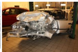
Рис. 4, 5. Предметний автомобіль і аналог з бази даних DSD ReconData EES Estimation (середня EES 56.5 км/г)
