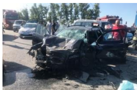
Рис. 4, 5. Предметний автомобіль і аналог з бази даних DSD ReconData EES Estimation (середня EES 56.5 км/г)
