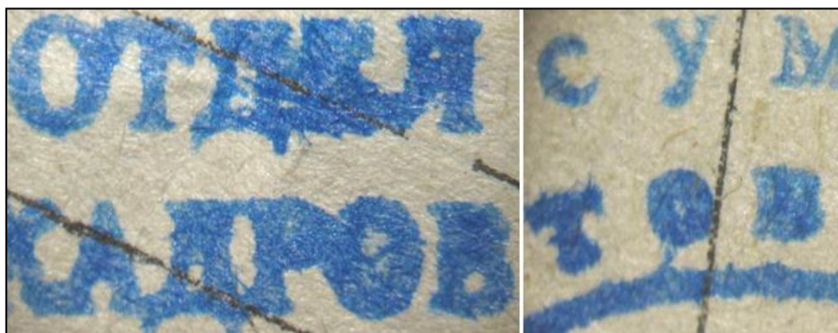
Рис. 2. Збільшені фрагменти відбитків печаток у документі, нанесених контактним способом посвідчувальною друкарською формою штемпельною фарбою
