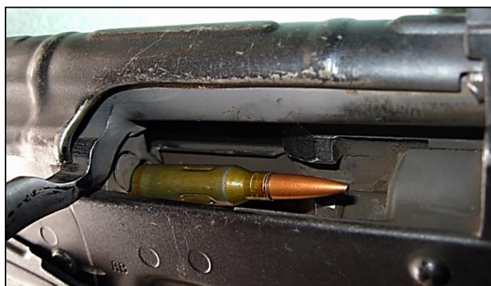
Рис. 3. Спосіб поміщення фланця 5,45-мм проміжного патрона зразка 1974 року під зуб зачепа викидача затвора автомата АКМ
