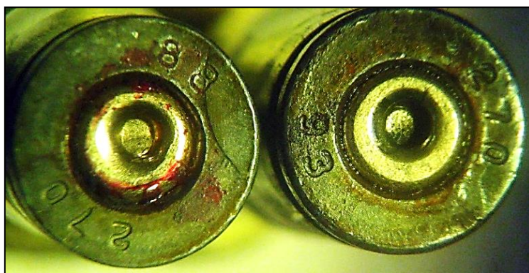
Рис. 6. Дно гільз 5,45-мм проміжних патронів зразка 1974 року, що були експериментально стріляні з наданого на дослідження автомата АКМ
