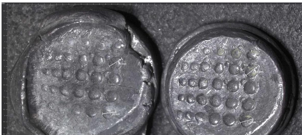
Рис. 2. Приклад тавра реверсу пломби лічильника газу, залишеного з різною силою натиску одною плашкою на двох заготовках
