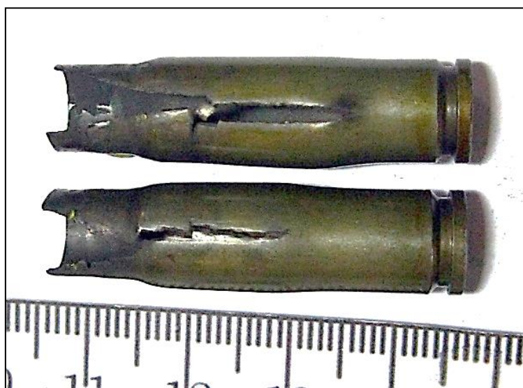
Рис. 5. Надана на дослідження гільза (зверху) та одна з експериментально стріляних з автомата АКМ гільз 5,45-мм проміжних патронів
