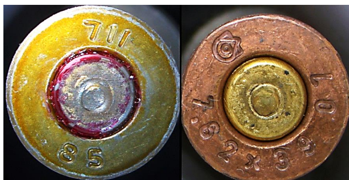
Рис. 4. Дно гільз 7,62-мм проміжних патронів зразка 1943 року, що були експериментально стріляні з наданого на дослідження автомата АКМ
