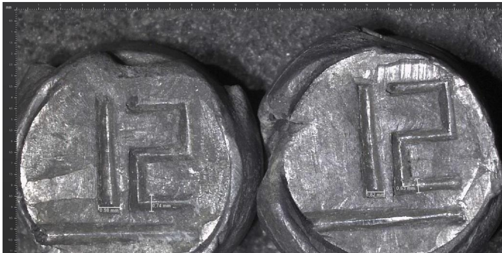
Рис. 1. Приклад тавра аверсу пломби лічильника газу, залишеного з різною силою натиску одною плашкою на двох заготовках
